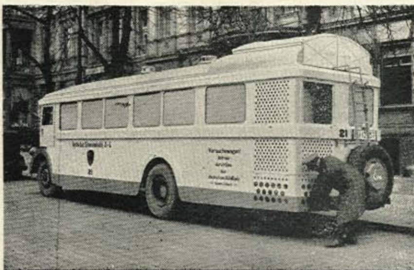
Ein Holzgasautobus. Der Holzgasgenerator ist unauffällig innerhalb der Karosserie im Heck des Wagens angebracht.
