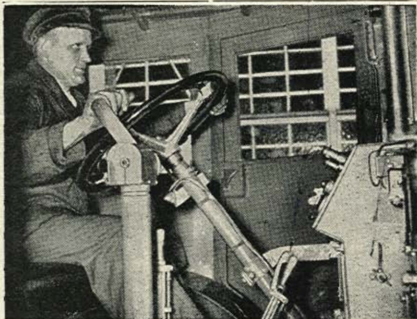
Ebenfalls unabhängig von ausländischem Treibstoff: Der Führerstand eines der neuesten Dampfkraftwagen.
