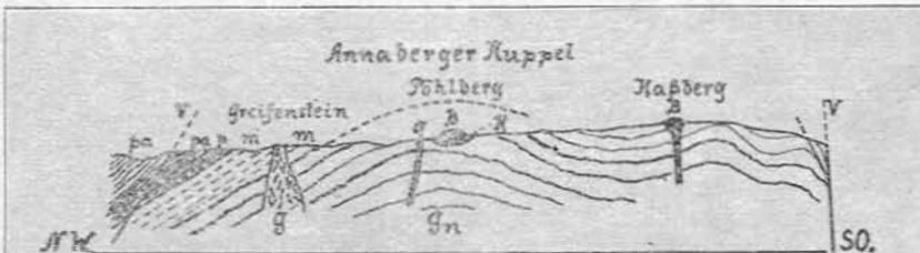
NW-SO-Profil von den Greifensteinen nach dem Haßberg. Zeichenerklärung: G-Gneis, G-Granit, m-Glimmerschiefer, p-Phyllit, pa-alte Sedimente, K-alltertiäre Kiese u. Sande, B-Basalt, V-Vierverfaltungen.
